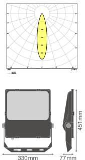
**Scheda tecnica Ledvance Proiettore LED Performance Nero 150W 18700lm 30D - 830 Luce Calda | IP66 - Simmetrico**
