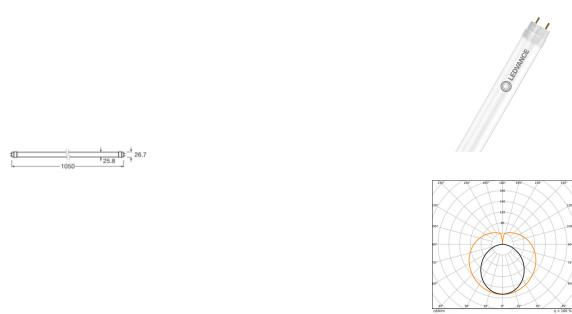
Scheda tecnica Ledvance Tubo LED T8 EM Superior (EM/Mains) High Output T8 11.4W 1800lm - 830 Luce Calda - | 105cm - Sostitutiva 38W
