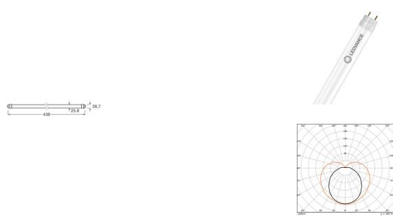
Scheda tecnica Ledvance Tubo LED T8 EM Value (EM/Mains) Standard Output 5.4W 585lm - 830 Luce Calda - | 44cm - Sostitutiva 15W
