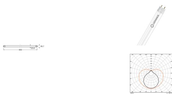
**Scheda tecnica Ledvance Tubo LED T8 EM Value (EM/Mains) Standard Output 10W 1200lm - 840 Bianco Freddo | 90cm - Sostitutiva 30W**
