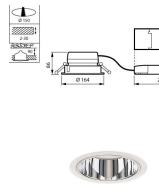
Scheda tecnica Philips Downlight LED LuxSpace Mini Profondo DN561B 7W 840lm 75D - 840 Bianco Freddo | 164mm - Aluminium Riflettore
