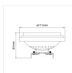
**Scheda tecnica Noxion Lucent Faretti LED G53 AR111 11.5W 880lm 40D - 930 Luce Calda | Miglior resa cromatica - Dimmerabile - Sostitutiva 75W**
