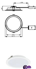
Scheda tecnica Philips Downlight LED Lediniare DN065B Meta IBianca 12W 1200lm 110D - 830-840-865 CCT | 175mm - Ritaglio 150mm - IP20
